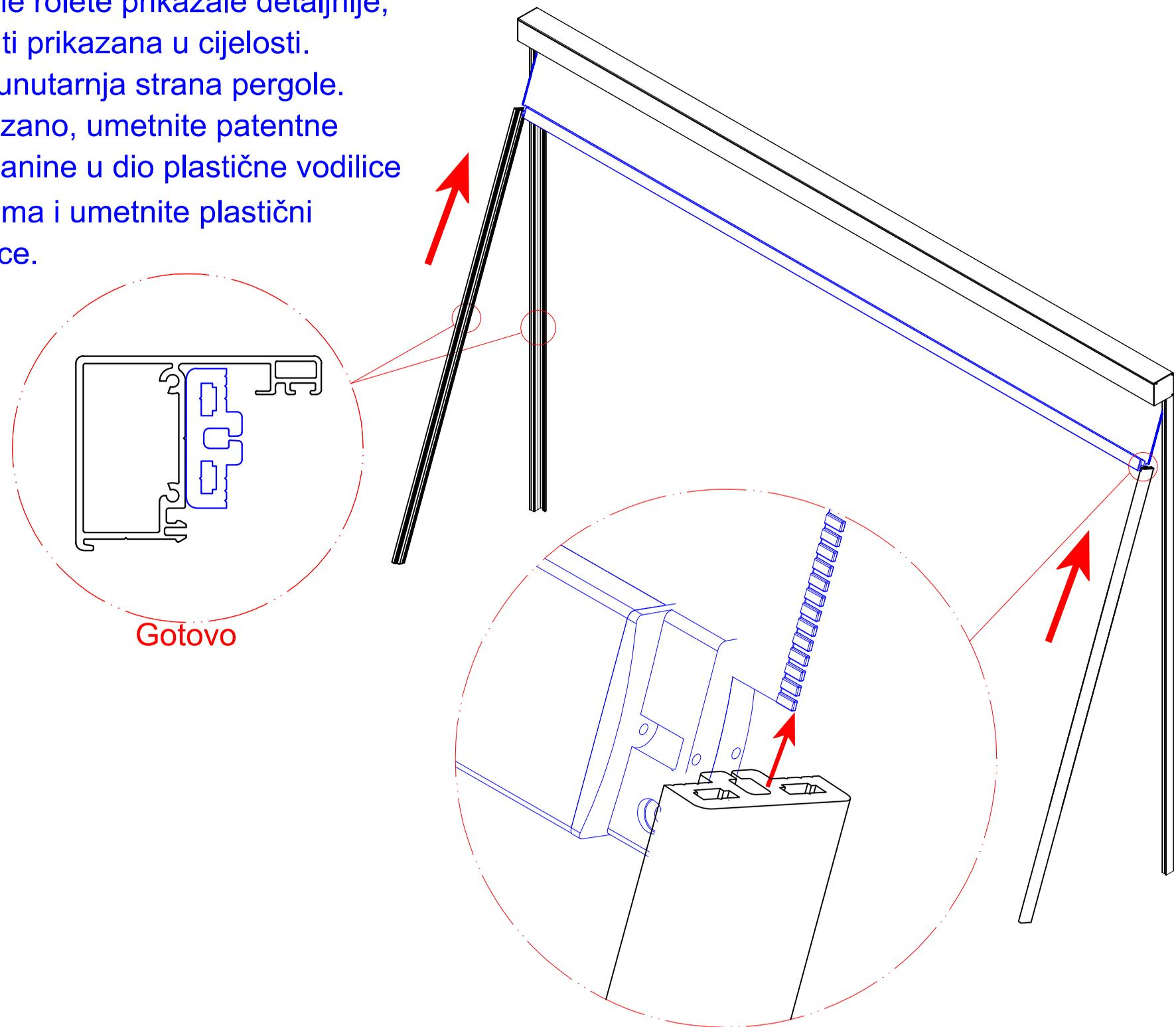
12. Učvrstite dio br. ① u dio br. ③ pomoću gumenog čekića. Prvo snažno udarite od vrha, a zatim udarajte do tla. Instalacija će biti dovršena kada ne bude razmaka između dijela br. ① i dijela br. ③.
