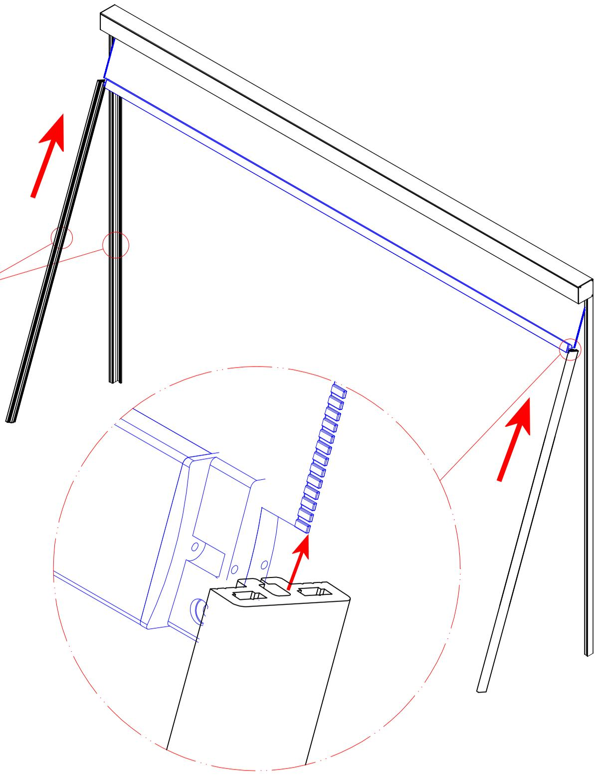
12. Mit einem Gummihammer Teil Nr. ① in Teil Nr. ③ befestigen. Schlagen Sie zuerst hart von oben und dann bis zum Boden. Die Installation wird abgeschlossen sein, wenn zwischen dem Teil Nr. ① und Teil Nr. ③ kein Schlitz vorhanden ist.
