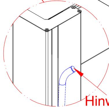
Hinweis: Das PVC-Rohr muss in der Drahtzuführungsöffnung platziert werden, ohne herauszustehen. Dann mit Kleber befestigen.
