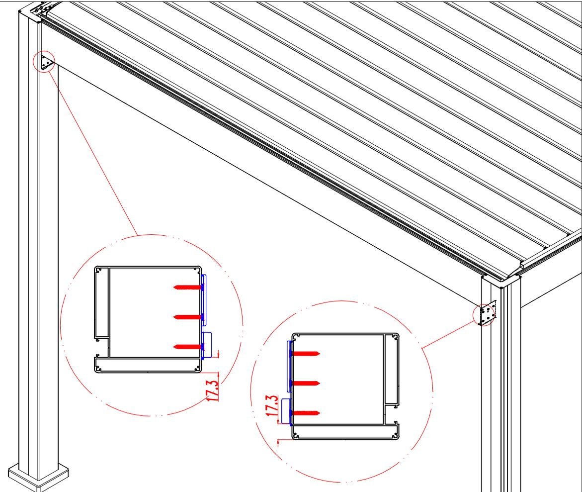
3. Ko stojite pod pergolo, obrnjeni proti odprtini, v katero bo nameščeno senčilo ziptrack, je treba nosilec z vgravirano oznako „L“ pritrditi na drog na levi strani, nosilec z vgravirano oznako „R“ pa na drog na desni strani.
