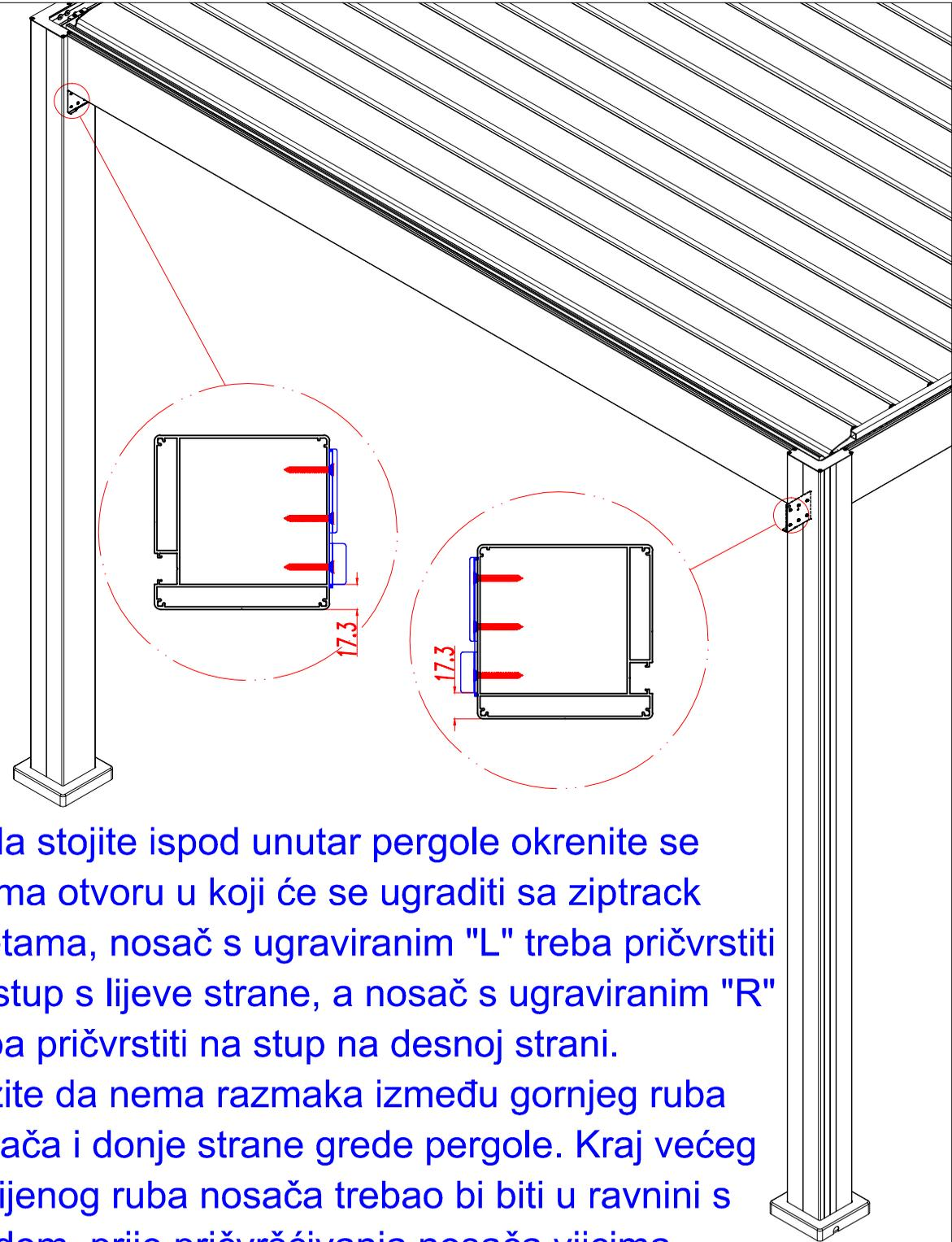
3. Kada stojite ispod unutar pergole okrenite se prema otvoru u koji će se ugraditi sa ziptrack roletama, nosač s ugraviranim "L" treba pričvrstiti na stup s lijeve strane, a nosač s ugraviranim "R" treba pričvrstiti na stup na desnoj strani.
