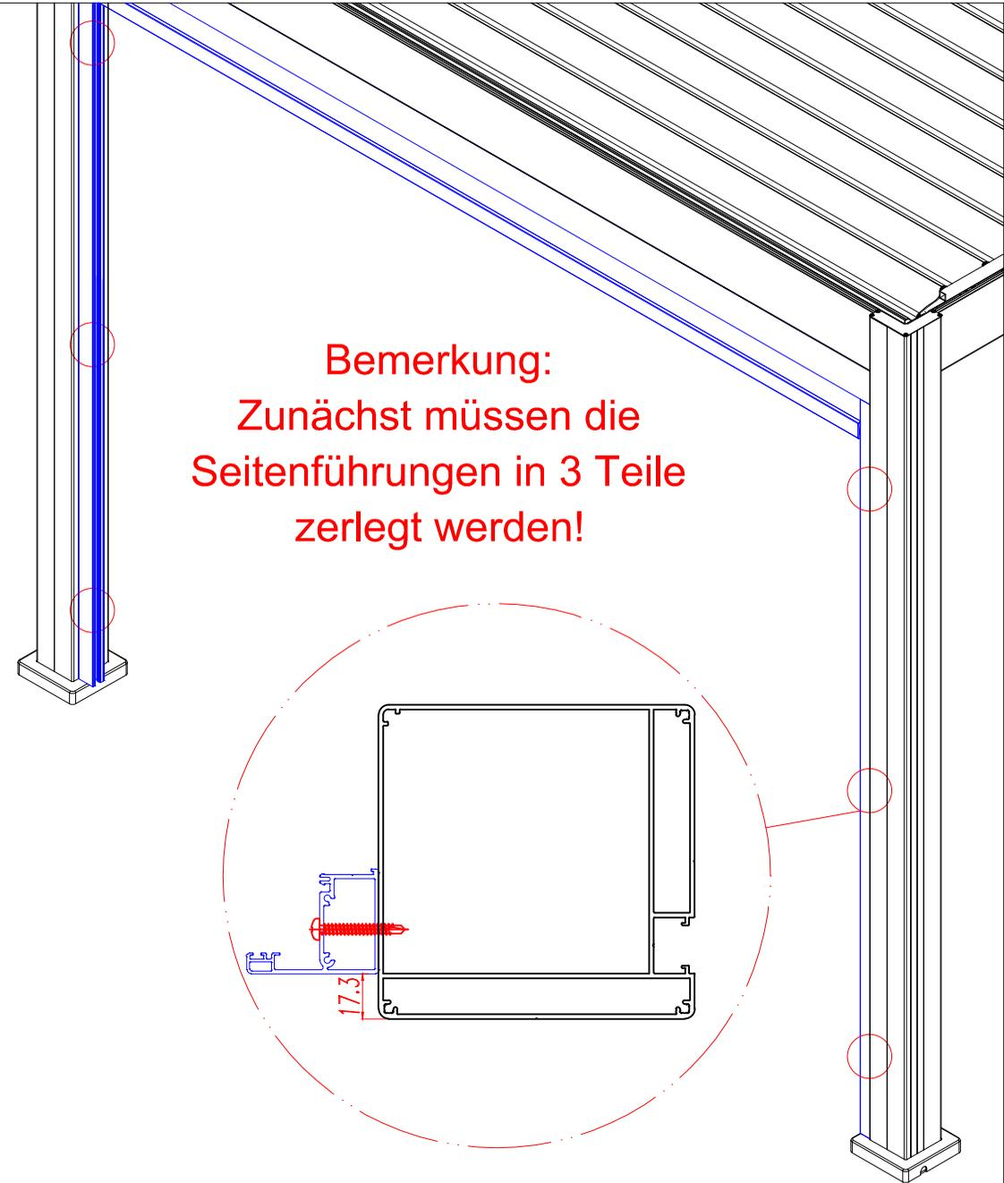
9. Stellen Sie Teil Nr. ③ 17.3 mm von der Außenseite der Säule ein und befestigen Sie dann die Seitenführung mit 3 Schrauben von der oberen, mittleren und unteren Position
