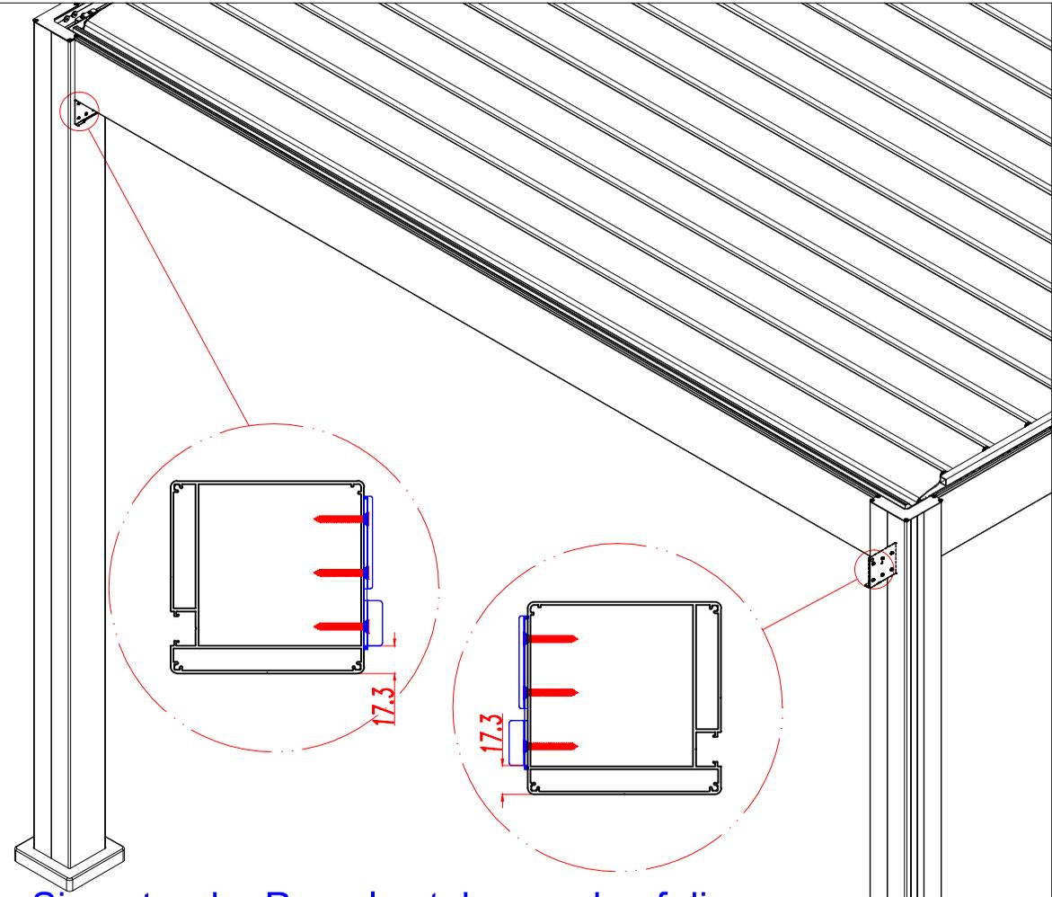
3. Wenn Sie unter der Pergola stehen und auf die Öffnung blicken, an der die Ziptrack-Sonnenblende installiert werden soll, befestigen Sie die Halterung mit der eingravierten Markierung „L“ an der Stange auf der linken Seite und die Halterung mit der eingravierten Markierung „R“ auf der Stange auf der rechten Seite.
