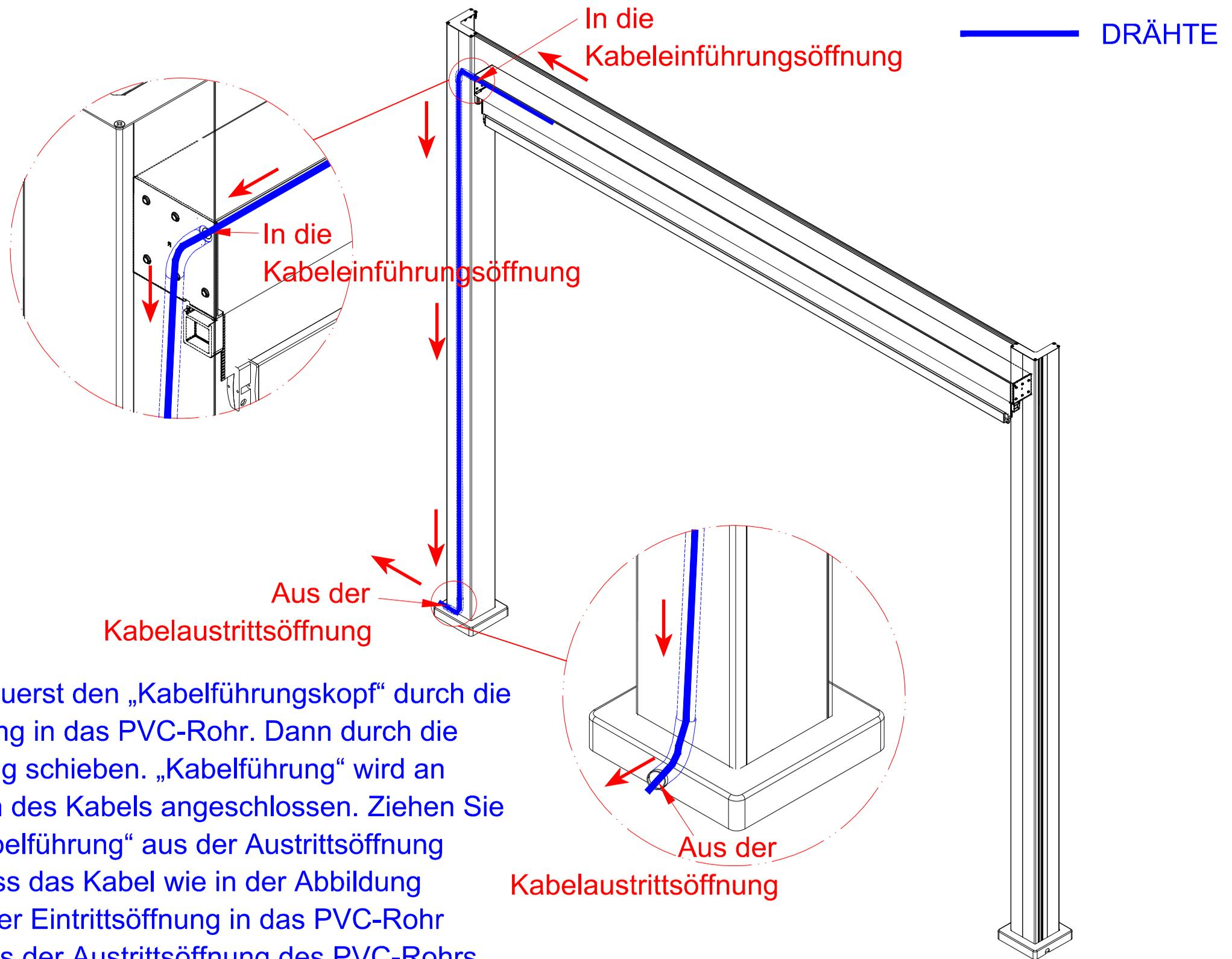
6. Stecken Sie zuerst den „Kabelführungskopf“ durch die Austrittsöffnung in das PVC-Rohr. Dann durch die Eintrittsöffnung schieben. „Kabelführung“ wird an beiden Enden des Kabels angeschlossen. Ziehen Sie dann die „Kabelführung“ aus der Austrittsöffnung heraus, sodass das Kabel wie in der Abbildung gezeigt von der Eintrittsöffnung in das PVC-Rohr eintritt und aus der Austrittsöffnung des PVC-Rohrs austritt.
