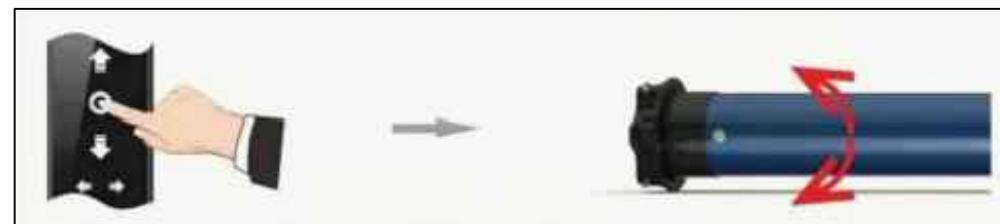
Opomba: Privzet način je blokada premikanja. Pritisnite in držite gumb UP ali DOWN 1,5 s, motor bo deloval neprekinjeno. Ko sta nastavljeni zgornji in spodnji mejni točki, motor samodejno preklopi v način neprekinjenega gibanja.
