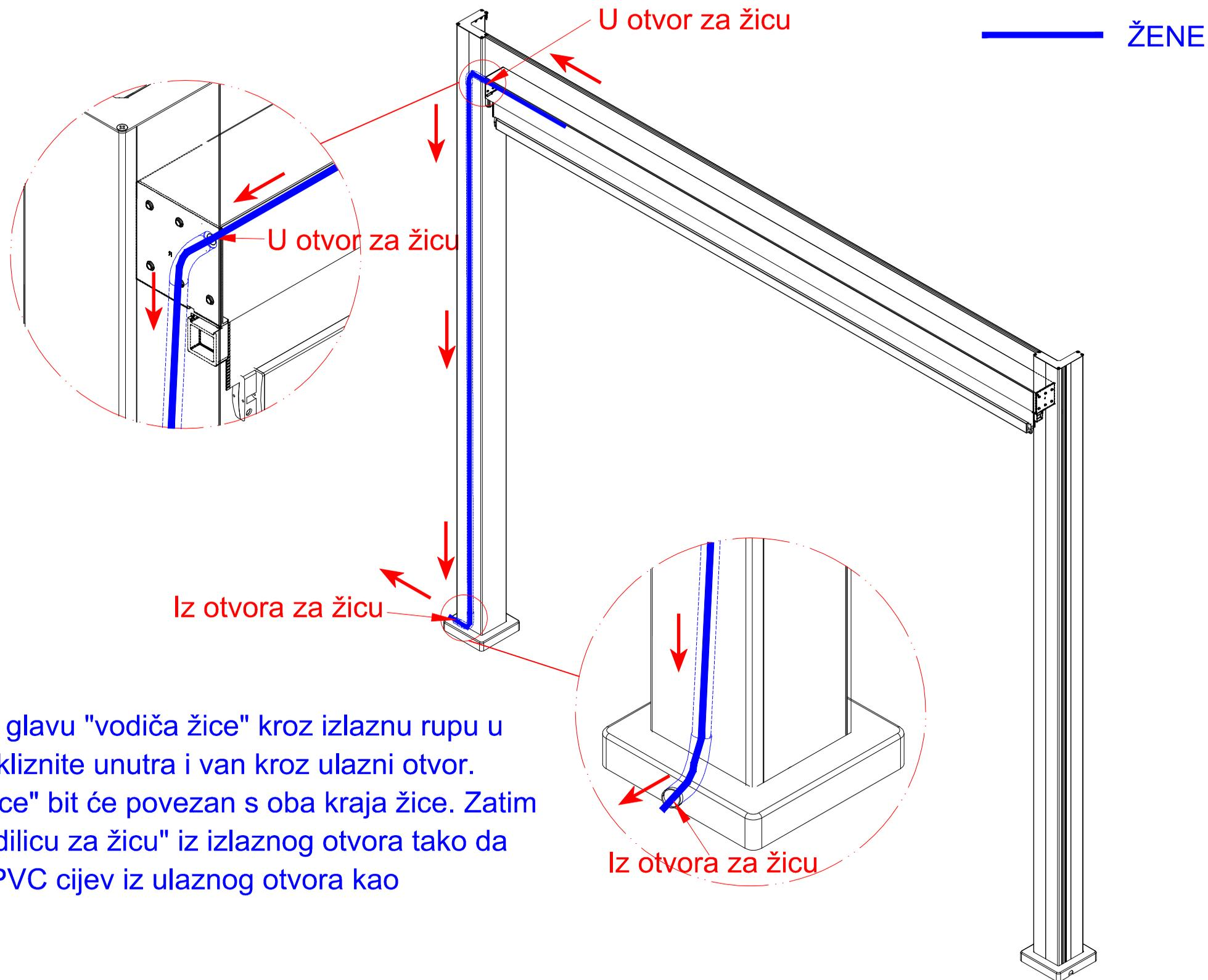
6. Prvo stavite glavu "vodiča žice" kroz izlaznu rupu u PVC cijev i kliznite unutra i van kroz ulazni otvor. "Vodič za žice" bit će povezan s oba kraja žice. Zatim izvucite "vodilicu za žicu" iz izlaznog otvora tako da žica uđe u PVC cijev iz ulaznog otvora kao
