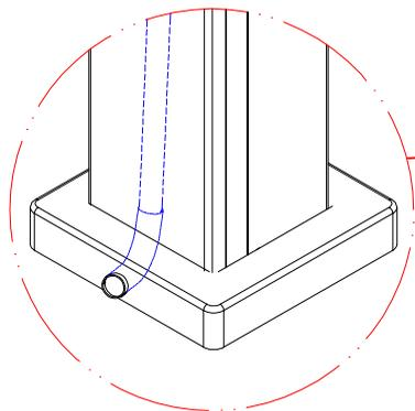
Die Öffnung für die Bodenplattenabdeckung muss an Ort und Stelle geschnitten werden.
